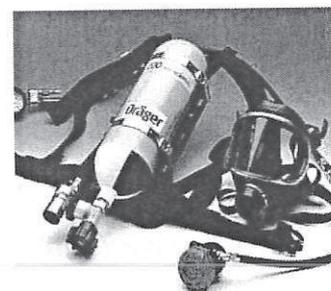
Si precisa che esistono autorespiratori funzionanti a domanda e pertanto l'afflusso d'aria sarà proporzionale alla richiesta; quelli che funzionano in sovrappressione l'aria affluirà in quantità maggiore, creando nel vano maschera una sovrappressione di circa 2,5 mbar che provvede ad una ulteriore protezione da eventuali infiltrazioni di
